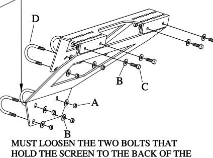
ROLL CAGE. MUST TIGHTEN ANY LOOSE **BOLTS ONCE BRACKET IS INSTALLED.**
