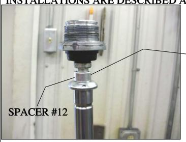
4TH STEP PLACE THE SPACER ON THE BALL JOINT ONTOP OF THE WASHER. MUST USE LOCKTIGHT ON THE THREADS OF THE BALL JOINT WHEN REINSTALLING ONTO THE SHAFT. THIGHTEN THIS JOINT TO FACTORY SPECS.
