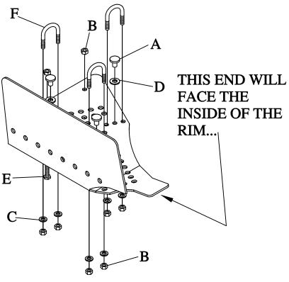
ONCE THE GUARDS HAVE BEEN INSTALLED UNDER THE A-ARMS MUST SLIDE THE GUARD UP UNTIL THESE BOLTS HAVE HIT THE BACK TUB. TOWARDS THE FRAME OF THE ARM.
