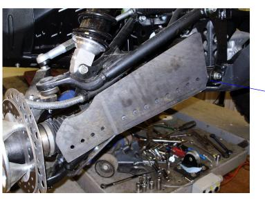
MAKE SURE TO PLACE THE SPACERS BETWEEN THE TABS AND GUARD BEFORE TIGHTENING ALL HARDWARE.
