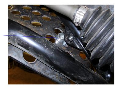
INSERT THE 1/4X1 1/4 BOLT WITH A WASHER ON EACH SIDE AND LOCK NUT ON THE INSIDE OF THE ARM.
