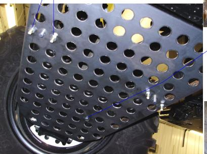
FINISHED PIC OF THE GUARD MOUNTED ONTO THE ARM. LOOKING FROM THE REAR OF THE BIKE.
