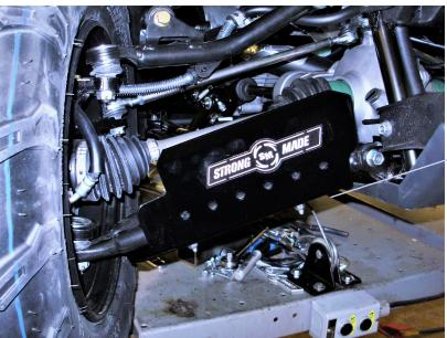
ONCE MOUNTED LIFT THE ATV OFF THE GROUND WITH A JACK TURN THE WHEELS FROM LEFT TO RIGHT TO MAKE SURE THE BRAKE OR BRAKE LINES WILL TOUCH ANY PART OF THE GUARDS. THIS IS A PIC OF THE RIGHT SIDE SITTING ON THE ATV.
