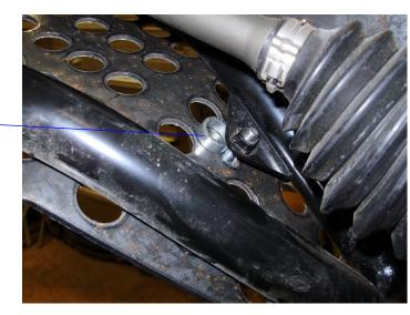
MAKE SURE TO PLACE THE SPACERS BETWEEN THE TABS AND GUARD ON ALL BOLTS BEFORE TIGHTENING ALL HARDWARE.
